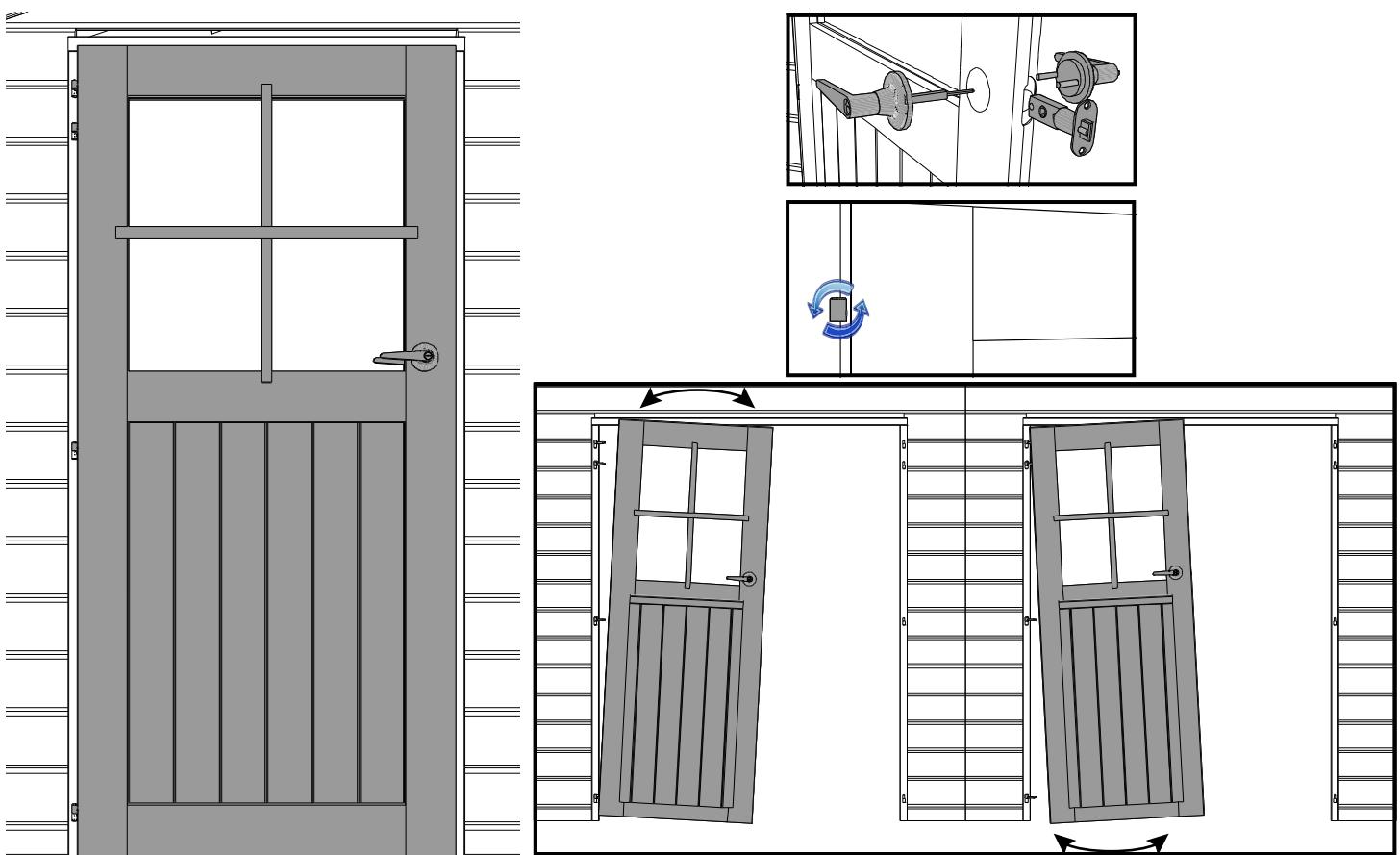
**NL:** Gedurende het jaar kan het voorkomen dat de deur niet meer goed sluit. U kunt deze eenvoudig dmv de scharnieren bijregelen.
